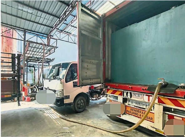
集裝箱羅里內有乾坤(右)，加裝1萬8000公升容量的鋼制方形儲油槽，以便為非法輸油掩人耳目。(雪內貿局提供)
