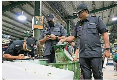
内贸部执法人员通过特殊铁块检查称重器材的准确性。(KPDN KL 提供)
